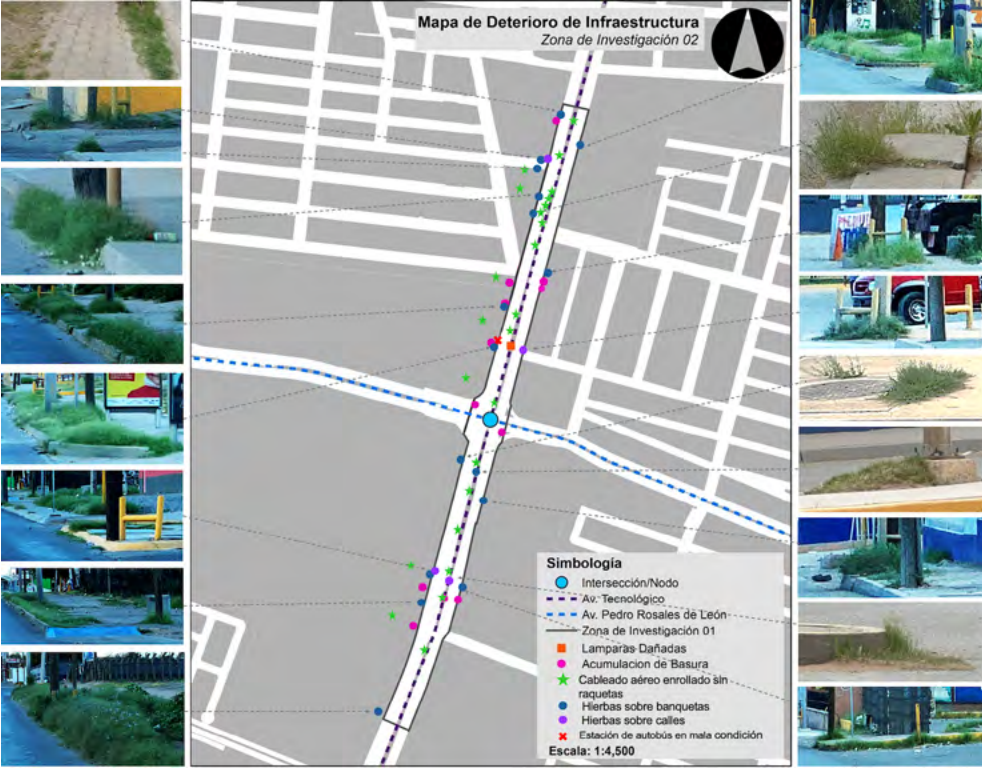
■ FIGURA 38. Mapeo de deterioro banquetas por hierbas y basura, tramo 2
