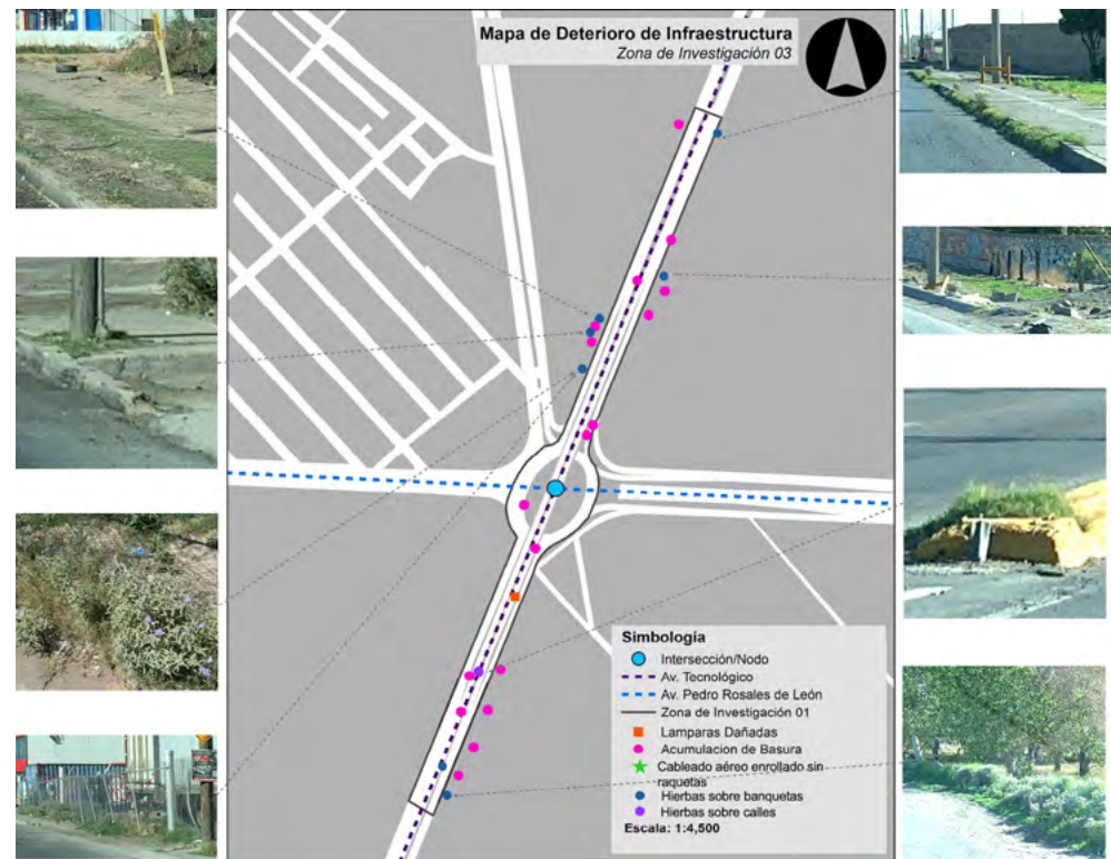
■ FIGURA 39. Mapeo de deterioro banquetas por hierbas y basura, tramo 3
