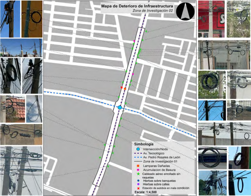
■ FIGURA 35. Mapeo de cableado aéreo fuera de norma, tramo 2
