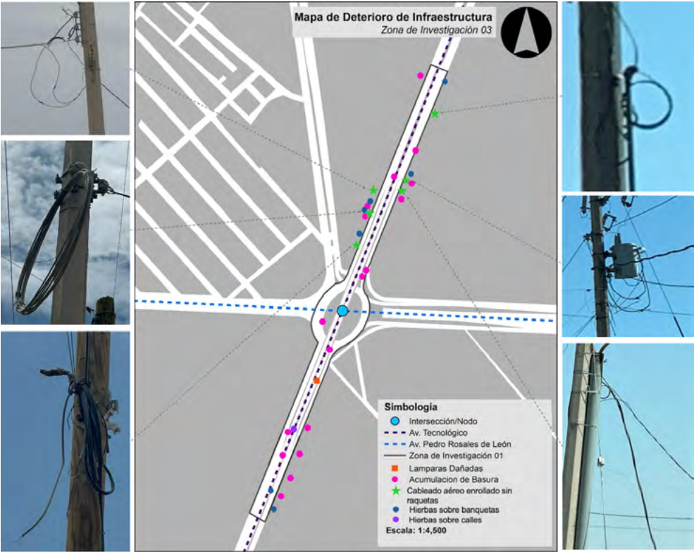
■ FIGURA 36. Mapeo de cableado aéreo fuera de norma, tramo 3
