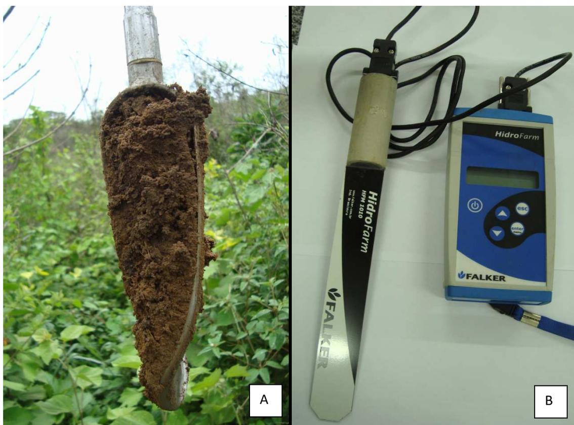
Figura 3. Amostragem de solos com trado (A) e medidor de umidade de solos (B).
